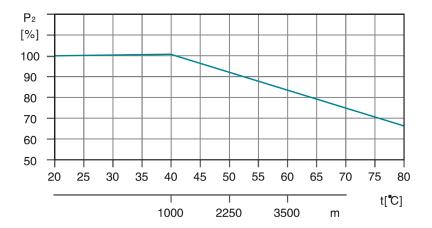
Por ejemplo, cuando la bomba se instala a una altitud de 3500 metros, P2 disminuirá en un 88%. Y cuando la temperatura ambiente es de 70 ° C, P2 disminuirá en un 78%.
